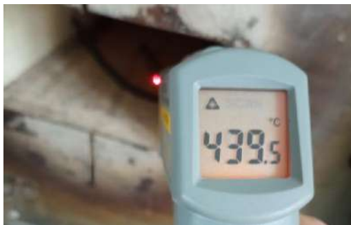
Рис. 1 – Термозагартування проводу Ni-Ti діаметром 0,9 мм
