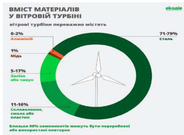
Рис. 2 – Вміст матеріалів у вітровій турбіні
