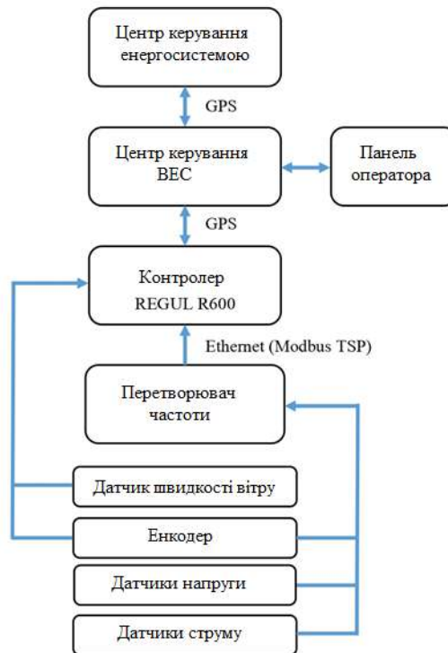
Рис. 1 – Архітектура системи автоматизації
