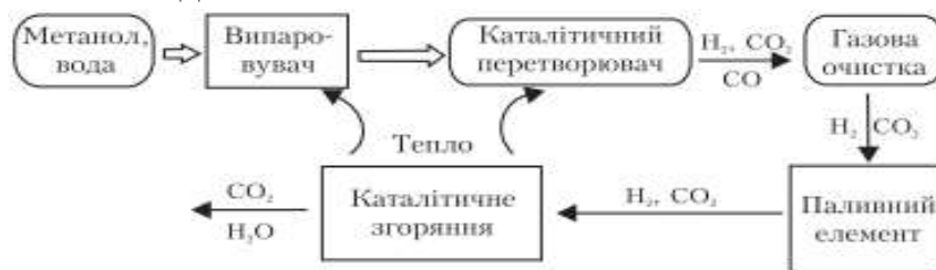
Рис.2 – Принцип роботи паливного елемента
