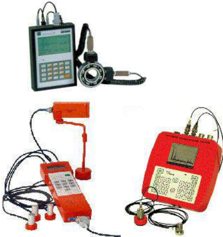
Рис. 5. Аналізатори вібрації, зліва направо: "СК-2300", "СМ-3001", "АДП-3101"
