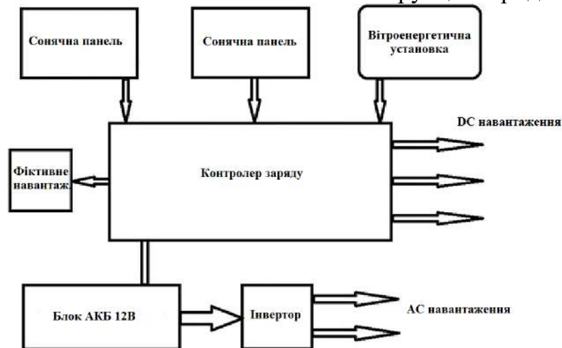
Рис. 2 – Структурна реалізація гібридної системи
