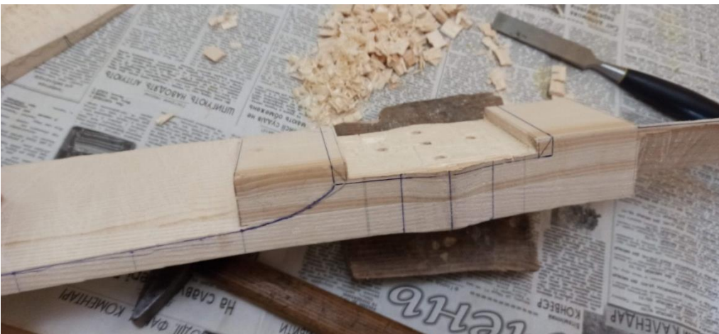
Рис. 3.46- Попередня поверхня підготовлена стамескою для отримання необхідної товщини маточини
