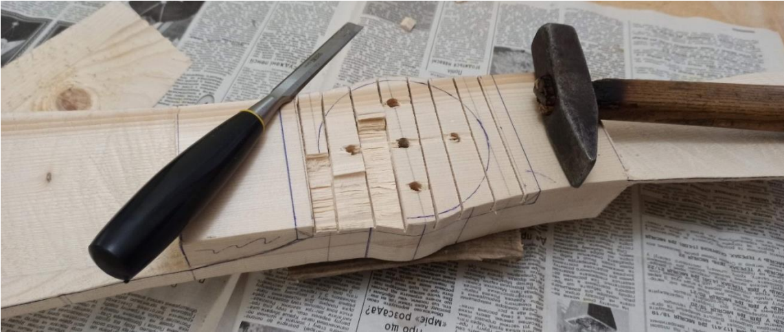
Рис. 3.45- Зачищення поверхні під маточину
