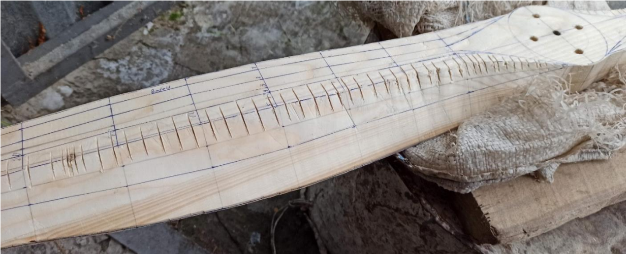
Рис. 3.57- Надпили надпили по верхній поверхні лопаті
