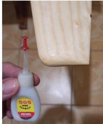
Рис. 3.73- Зміцнення поверхні використовуючи клей 505
