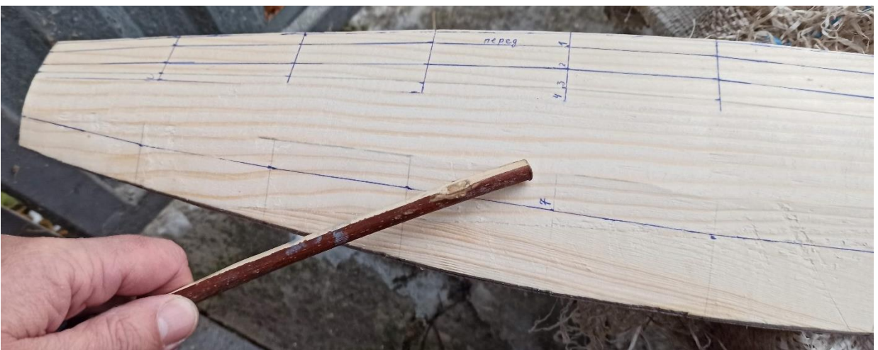
Рис. 3.59- Зачистка верхньої поверхні
